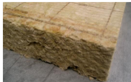
Steenwol (met een hoge ontbrandingstemperatuur) zal niet bijdragen aan branduitbreiding.
