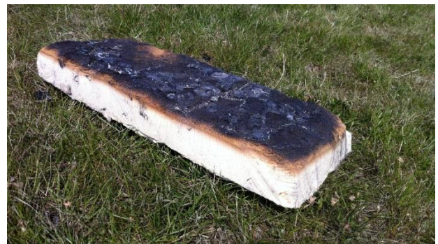
Een PIR FM approval die is gecarboniseerd als gevolg van een naburige brand (>50 KW/m 2 straling).
