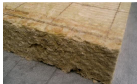
Steenwol (met een hoge ontbrandingstemperatuur) zal niet bijdragen aan branduitbreiding.
