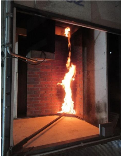
SBI-test op een stenen muur Bron: Peutz
